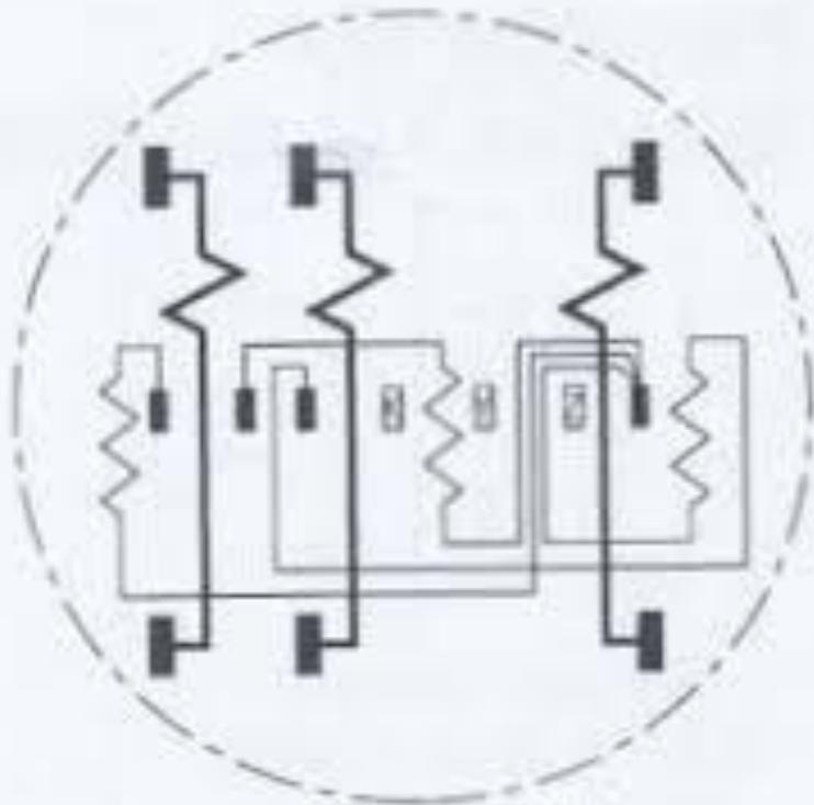
Meter Internal Wiring
