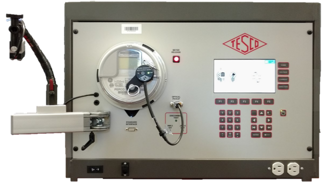
MTB-3050 illustré avec bras électromécanique en option et Capteur optique Cat. 1037-DTS.
