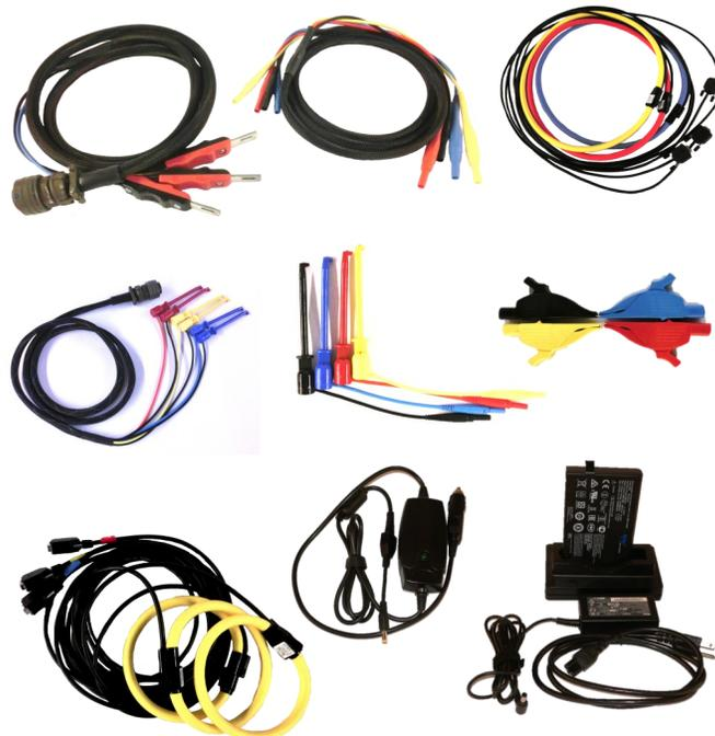
\* El kit liviano de TESCO que se muestra en la imagen incluye la unidad 6330, el paquete de baterías B00-001, el captador óptico 1037-SA, los puentes de corriente CJ0-6330-002, el cable de corriente CCO-6330-002, el cable de voltaje VCO-6330-002, el VTO-6330-001 Clips de prueba y sonda de corriente Rogowski P01-0040-R. Peso total: 8 kilos.
