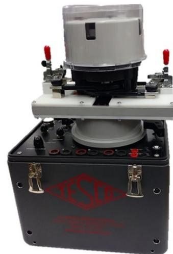
Adaptateur K-Base avec Cat. 630 Kit de test sur le terrain à liaison fermée (non inclus).
